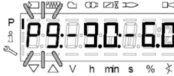
**Atención:** Durante la primera calibración del quemador, es aconsejable establecer el punto de máxima potencia al mismo valor que el punto de encendido (o ligeramente superior), con el fi de lograr trabajar en el punto P9 de una forma segura (Véase el párrafo siguiente)
