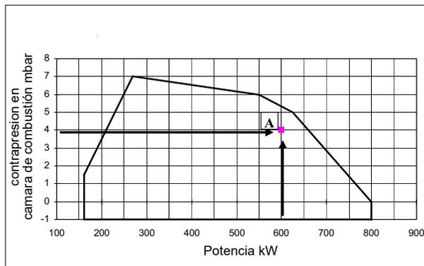
Trazar, en el diagrama "Campo de trabajo" del quemador una rectal vertical en correspondencia con la potencia del fuego y una recta horizontal en correspondencia con el valor de presión que interesa. El quemador es idóneo solamente si el punto de intersección "A" de las dos rectas cae dentro del campo de trabajo. Los datos corresponden a condiciones estándares: presión atmosférica igual a 1013 mbar, temperatura ambiente igual a 15° C.
