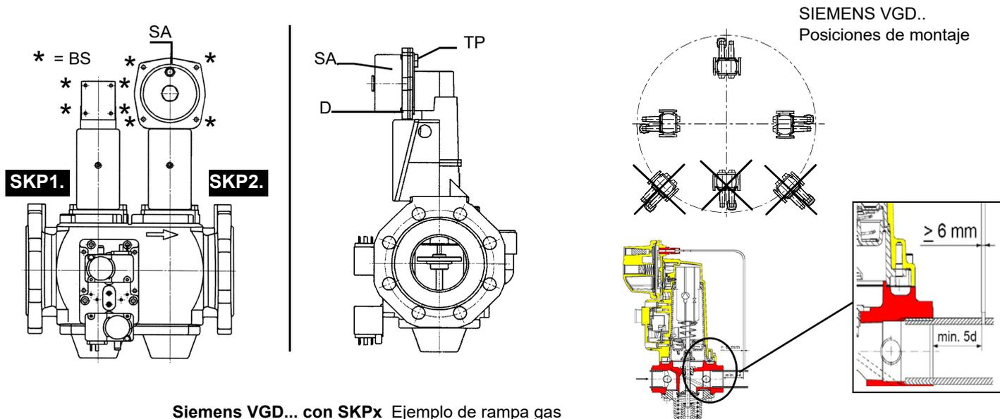
Siemens VGD... con SKPx Ejemplo de rampa gas
