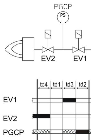
Si todas las fases antes enumeradas son realizadas con éxito, la prueba de estanqueidad puede considerarse concluida de forma positiva. De lo contrario, se producirá un bloqueo del quemador. Para LMV5x, LMV2x/3x y LME73 (excepto para LME73.831BC), el control de estanqueidad puede ser configurado de modo que se produzca en el encendido, apagado o ambos.
