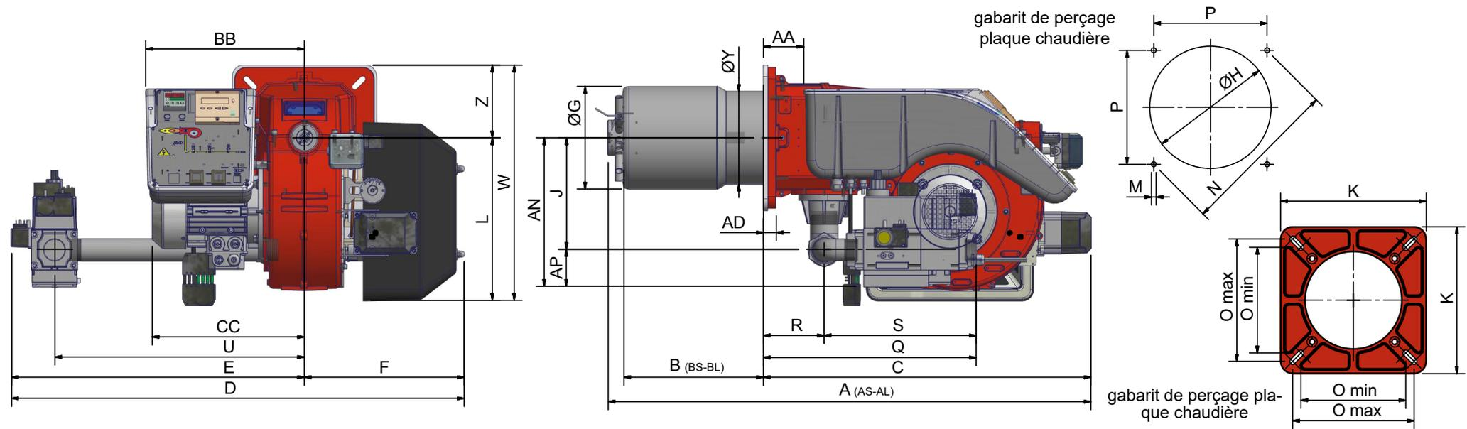
BS = dimension relative au brûleur avec tête standard boccaglio    BL = dimension relative au brûleur avec tête longue    DN = diamètre vannes gaz
