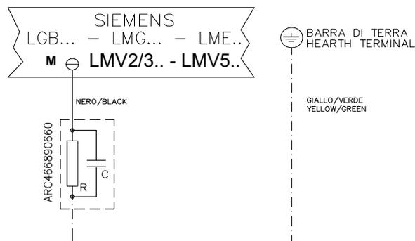
Dans le cas des brûleurs équipés de LMV 5x , voir les exigences des données du système de câblage de Siemens dans le CD ci-joint
