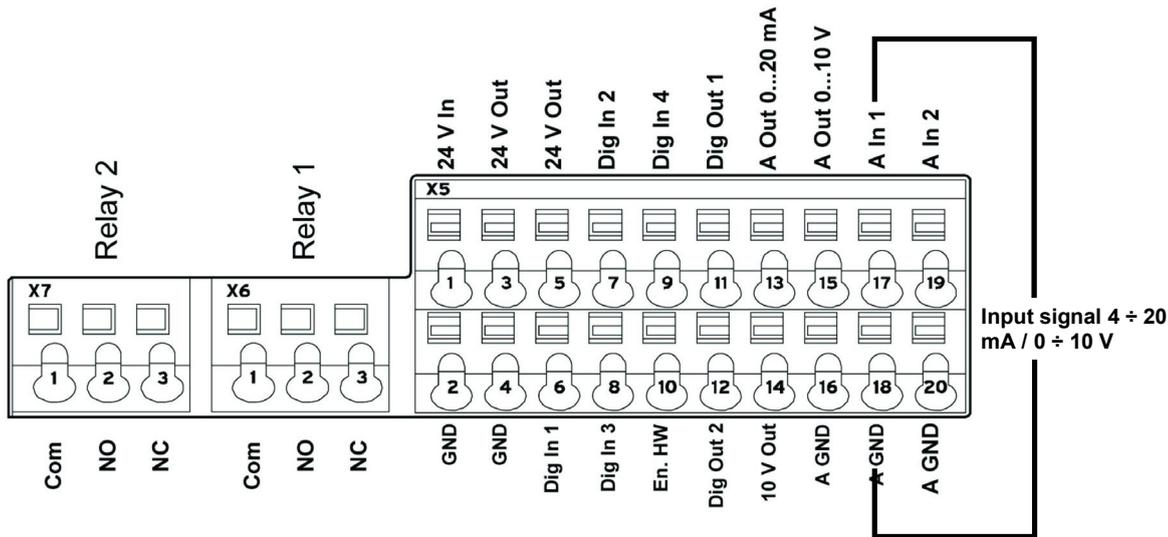
L'entrée AIn1 peut être configurée comme une entrée de tension ou de courant; pour LMV5- Etamatic est configuré comme une entrée de courant 4-20mA; pour LMV2x/3x comme une entrée de tension 0-10V.
