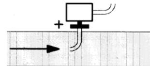
**Conexión sonda de presión Siemens QBE2...P...**
