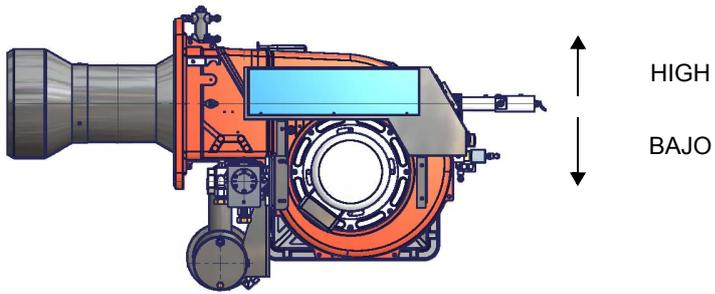
Fijar la brida del quemador en posición perfectamente horizontal a fin de obtener la inclinación correcta del barrilete de precalentamiento
