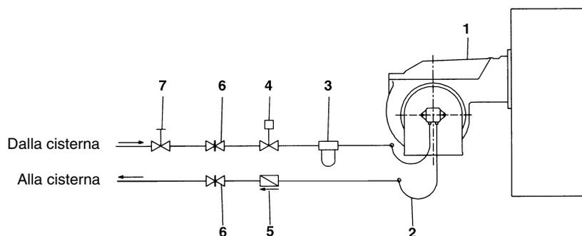
Fig. 21 - Sistema bitubo
