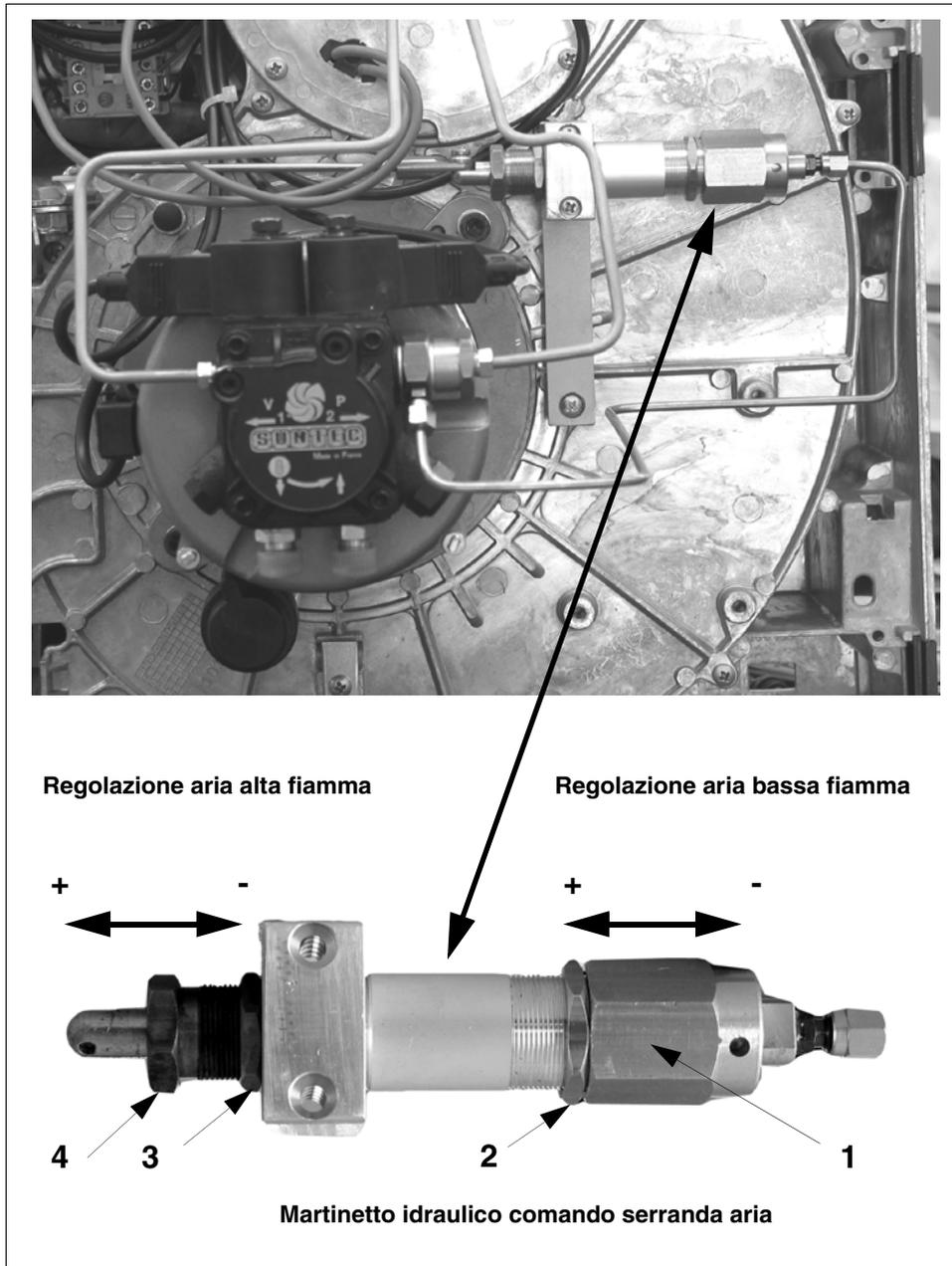
**Regolazione aria (eseguire prima la taratura della bassa fiamma)****a) Taratura bassa fiamma**
