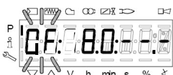
Если необходимо ввести угол открытия воздушной заслонки “0A” в точке розжига (например  $10^\circ$  - см. ниже) нажать “A” и одновременно “+” или “-”:
