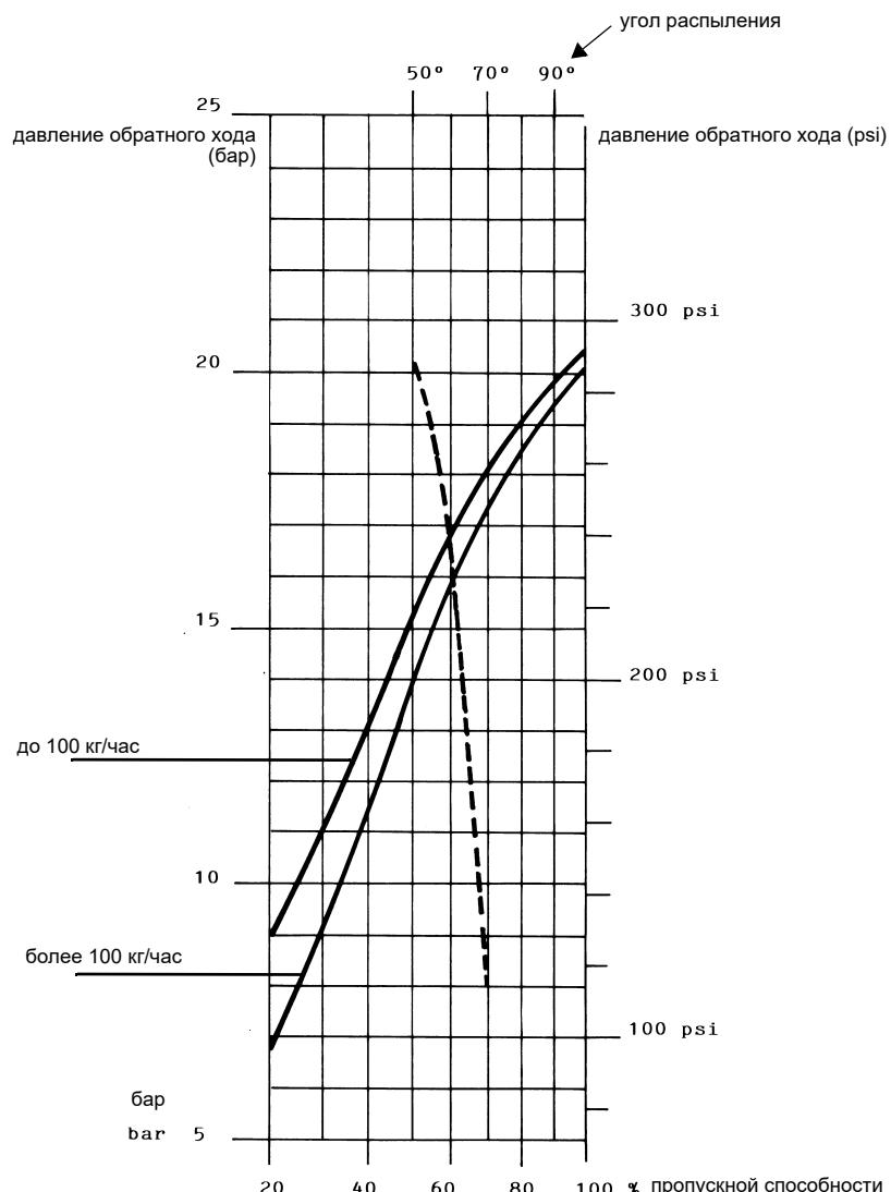
ДАВЛЕНИЕ ТОПЛИВА НА ФОРСУНКЕ = 25 бар
