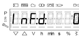
Для того, чтобы выполнить сброс блокировки, нажать кнопку **InFo** на одну секунду. Зарегистрировать номера и проверить в таблице ошибок тип аварийного случая.
