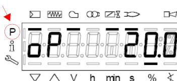
Тире рядом с символом “P” (выделенный на рисунке) исчезнет, указывая на то, что менеджер вышел из модальности программирования. Таким образом, горелка будет работать автоматически, согласно запрограммированной рабочей кривой.
