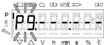
продолжать программирование вышеописанным способом, для ввода значений открытия сервоприводов воздуха (**A**) и топлива (**F**) и возможного инвертера (**F+A**) для LMV37
