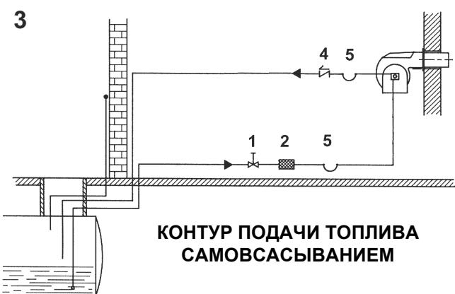
КОНТУР ПОДАЧИ ТОПЛИВА САМОВСАСЫВАНИЕМ
