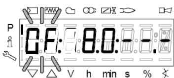
Если необходимо ввести угол открытия воздушной заслонки “OA” в точке розжига (например  $10^\circ$  - см. ниже) нажать “A” и одновременно “+” или “-”:
