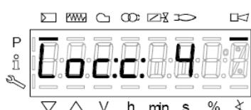
то это означает, что горелка заблокирована (Lockout) с кодом ошибки (Error code): на примере “Код ошибки”: 4. Также будет
