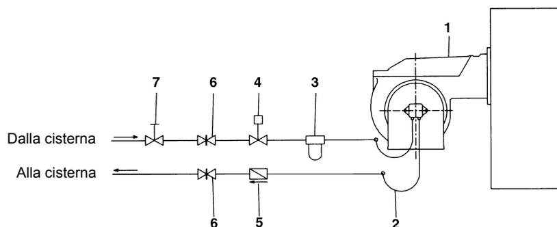
Fig. 9 - Sistema bitubo
