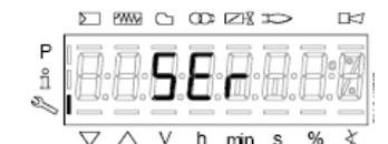
Il livello Service permetti di visualizzare informazioni sull’intensità di fiamma, posizione servocomandi, numero e codici di blocco:
