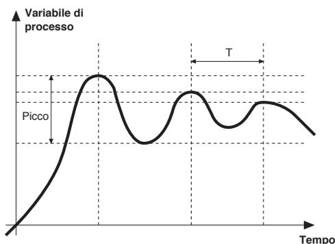
D) Calcolo dei parametri PID: Valore di banda proporzionale
