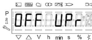
Significa che l'unità non è mai stata programmata o che non è impostato un tipo di funzionamento (rampe combustibile) o che non è stata configurata completamente.
