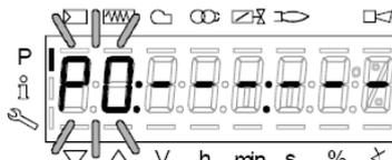
Premere "F" e "+" per aumentare l'angolo di apertura del servocomando combustibile "0F" fino al valore desiderato (per esempio 12° ÷ 15° -vedi sotto) per il punto di accensione oppure "F" e "-" per diminuire l'angolo:
