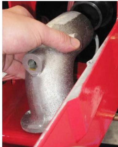
**⚠ ВНИМАНИЕ:** при обратном монтаже коллектора не забыть вставить уплотнительное кольцо “O”. На фазе центровки голов сгорания, не затягивать полностью винты на основании коллектора. Затянуть их после центровки. Не трогать винты шарнирного соединения и фланца горелки.
