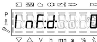
Для того, чтобы выполнить сброс блокировки, нажать кнопку **InFo** на одну секунду. Зарегистрировать номера и проверить в таблице ошибок тип аварийного случая.
