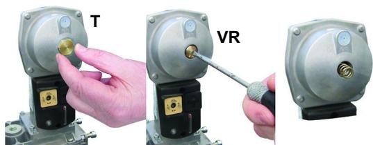
Для замены прилагаемой к клапанной группе пружины, действовать следующим образом:
