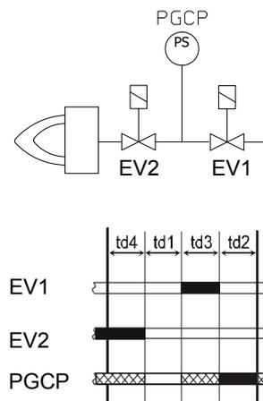
В том случае, если все вышеперечисленные фазы прошли с успехом, тест на герметичность можно считать завершенным положительно. В обратном случае произойдет блокировка горелки.
