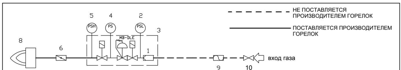
Газовая ramпа с группой клапанов VGD иМВЕ со встроенным стабилизатором давления газа + Реле давления газа для контроля за утечками (PGCP)
