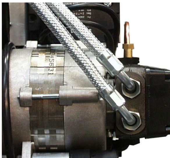
Aplicar la arandela de goma sobre los flexibles y sobre el cable de alimentación como se muestra en la figura; montar además la placa sujetacables (C).
