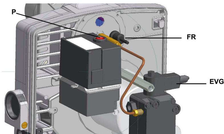
El caudal del combustible se regula utilizando boquillas cuyas dimensiones sean adecuadas a la potencia de la caldera/usuario y calibrando la presión de envío de la bomba (véase el esquema del circuito combustible en la figura). Para la elección de las boquillas, véanse las referencias indicadas en la ; por la regulación de la presión de la bomba se tiene que utilizar el tornillo de regulación indicado al párrafo “Bomba Gasoleo”.
