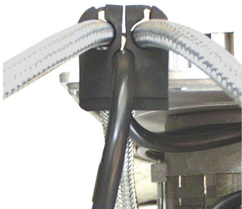
Introducir la arandela de goma en el compartimiento apropiado del caracol del quemador y fijar el tornillo **V**.
