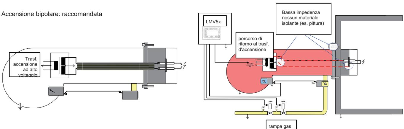
**Se viene utilizzato una accensione a polo singolo**, è molto importante avere bassa impedenza sulle connessioni di tipo meccanico (nessun materiale isolante es: vernice), in modo da ottenere un buon flusso di corrente dalla scintilla di accensione fino al trasformatore di accensione, assicurando basse emissioni EMC.
