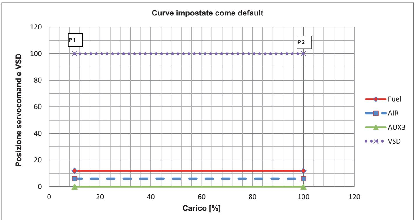
In questo modo, chiudendo la serie termostatica, il bruciatore, dopo l'accensione, si posiziona al carico minimo **P1** e successivamente procede verso il carico massimo **P2**, senza però incrementare la potenza erogata, poiché in entrambi i punti della curva, tutti gli attuatori sono regolati con la stessa apertura ai minimi valori.
