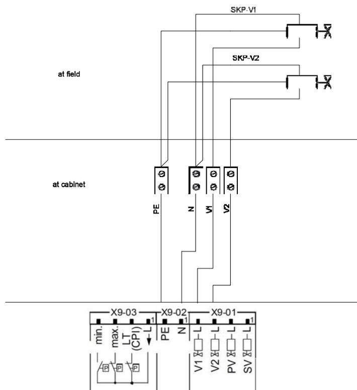
I cavi delle LMV5 alle SKP / VGD-Gas devono essere collegati al lato LMV5 con X9-01: L-Valve1, L-Valve2 e X9-02, N, PE) e collegati al lato SKP separati da ogni SKP.
