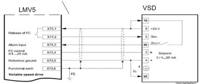
**Note:** Se l'LMV5 è montato in un armadio, in alternativa a (X73.6 / FE), è anche possibile connettere il cavo PE in armadio
