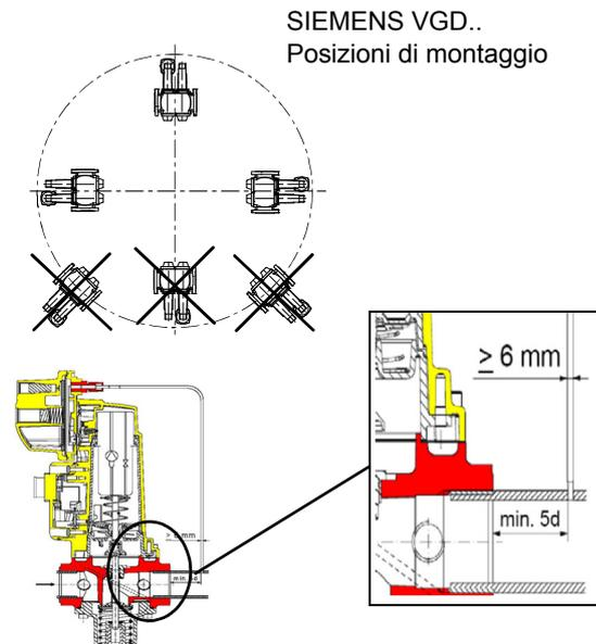
**Siemens VGD versione con SKP2 (stabilizzatore di pressione incorporato)**
