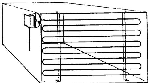
Disporre su tutta la sezione del canale, distanza minima dalle pareti 50mm, raggio di curvatura 10mm per le sonde da 2 o 6 m.
