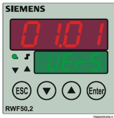
Per visualizzare la versione software dello strumento premere **Enter + freccia sù** .
