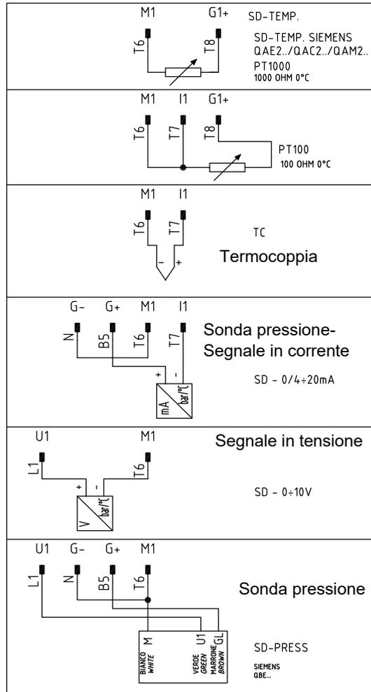
Fig. 19 - Schema di collegamento sonde per bruciatori modulanti
