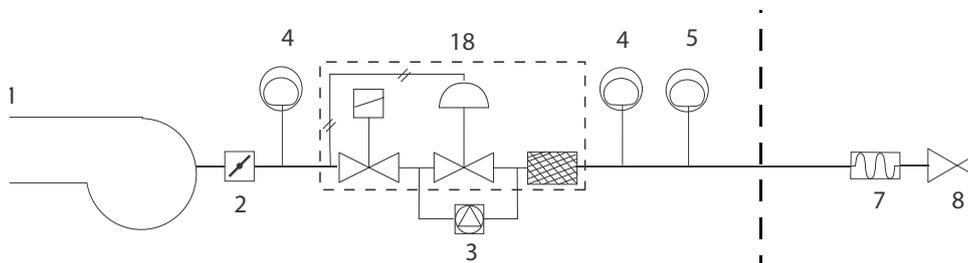
DN65 - DN80: Rampa con gruppo valvole MBC (2 valvole + stabilizzatore di pressione) + controllo di tenuta VPS504
