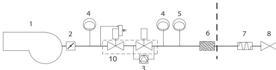
Rp2: Rampa con gruppo valvole MBC (2 valvole + filtro gas + stabilizzatore di pressione) + controllo di tenuta VPS504
