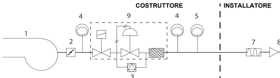
Rp2 - DN65 - DN80: Rampa con gruppo valvole VGD con stabilizzatore di pressione gas incorporato + controllo di tenuta VPS504.
