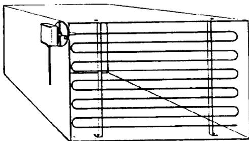
Disporre su tutta la sezione del canale, distanza minima dalle pareti 50mm, raggio di curvatura 10mm per le sonde da 2 o 6 m.
