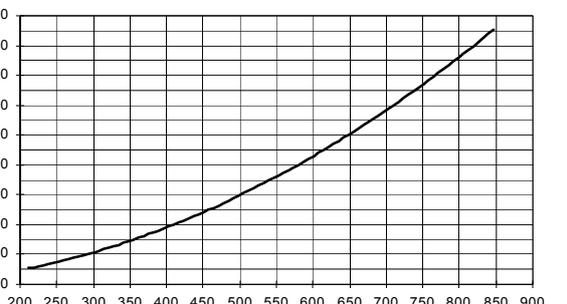
**Curve pressione in testa di combustione - portata gas (GPL)**
