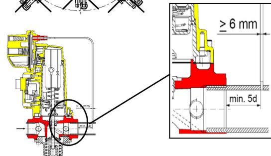
Siemens VGD... con SKPx Ejemplo de rampa gas
