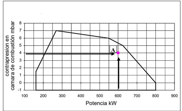
Trazar, en el diagrama "Campo de trabajo" del quemador una recta vertical en correspondencia con la potencia del fuego y una recta horizontal en correspondencia con el valor de presión que interesa. El quemador es idóneo solamente si el punto de intersección "A" de las dos rectas cae dentro del campo de trabajo. Los datos corresponden a condiciones estándares: presión atmosférica igual a 1013 mbar, temperatura ambiente igual a 15° C.
