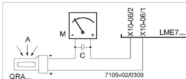
Рис. 10 - Контроль пламени с помощью фотоэлемента QRA.
