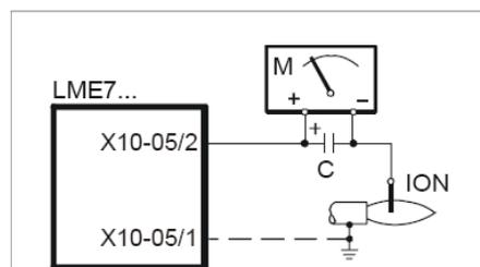
Рис. 9 - Контроль пламени с помощью электрода
