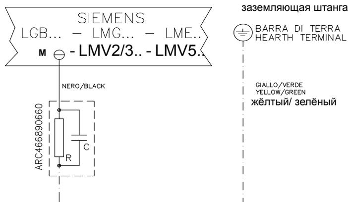
В том случае, если горелки оснащены менеджерами горения LMV5x, проконсультироваться с прилагаемыми предписаниями фирмы Siemens по электрическому монтажу установки, имеющимися на прилагаемом компакт-диске .
