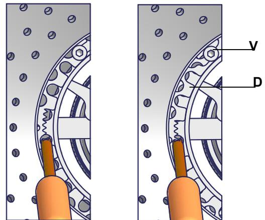
El disco se debe regular durante la puesta en funcionamiento de la instalación.
