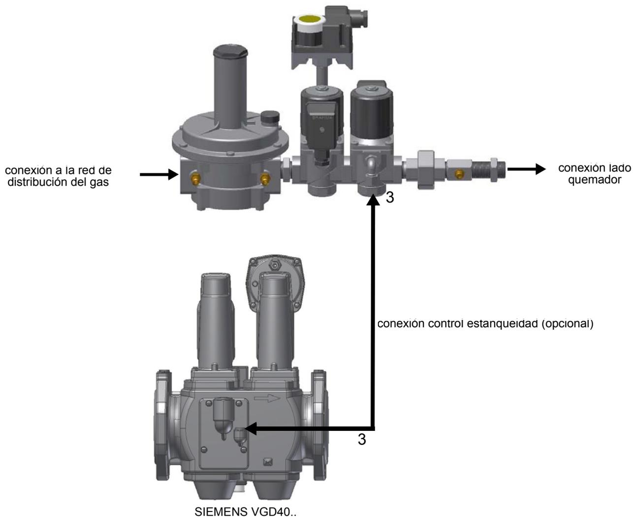
empalme (3) tubo de rampa piloto al grupo válvulas de la rampa principal (en el esquema no está previsto pero se puede realizar)
