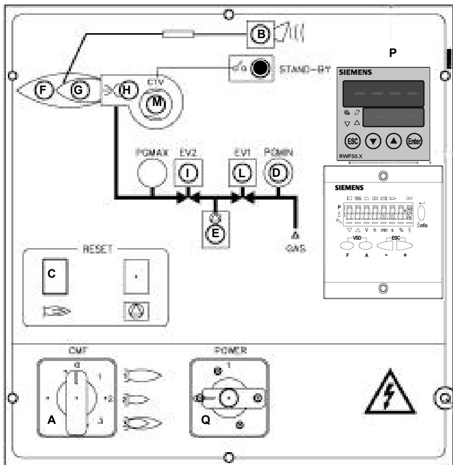
Рис. 22 - Передняя панель электроощита
