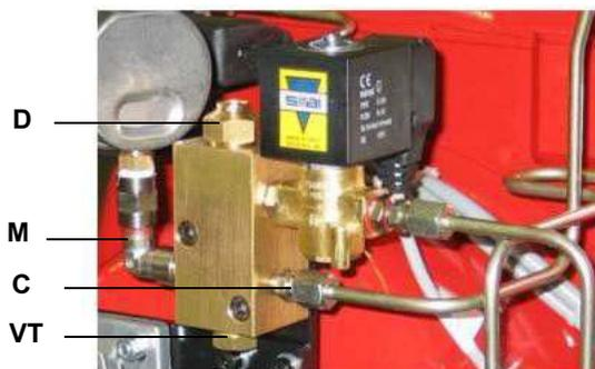
Рис. 29 - Ручной регулятор жидкого топлива
