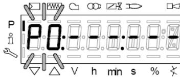
Pulse el botón "F" y "+", para aumentar el ángulo de apertura del servomotor de combustible "0F" hasta el valor deseado (por ejemplo 12°÷15° - Véase más adelante) para el punto de encendido pulse "F" y "-" para disminuir el ángulo:
