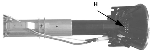
**ATENCIÓN:** para no afectar el funcionamiento del quemador, evitar el contacto de los electrodos de encendido y detección con partes metálicas (cabeza, boca, etc.) Controlar la posición de los electrodos después de cada intervención de mantenimiento en la cabeza de combustión.
