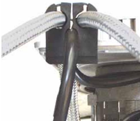
Rimontare la piastrina fermacavi **C**. Infilare il gommino nell'apposita sede nella coclea del bruciatore; fissare la viti **V**.
