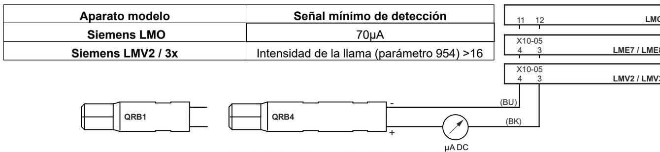
Fig. 1: Detección con fotocélula QRB4 - QRB1
