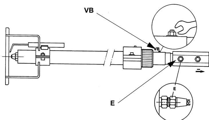
**Correcta posición de los electrodos y del cabezal de combustión.**
