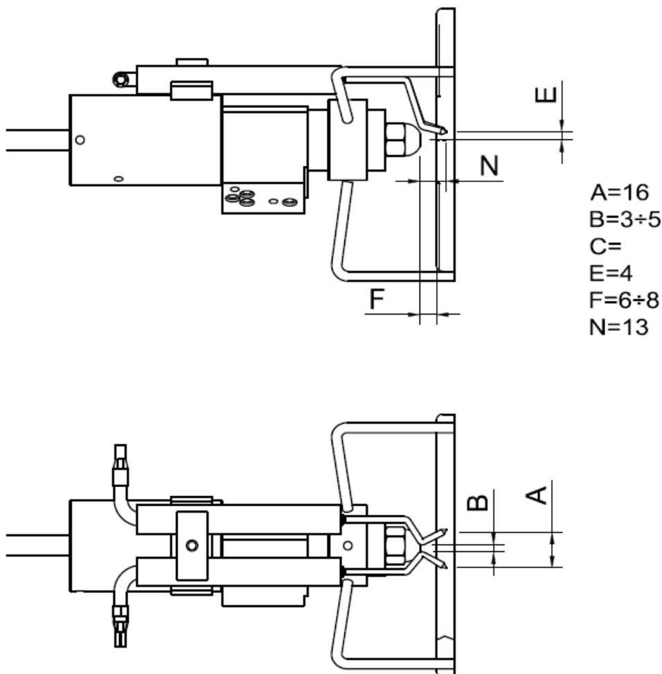
**Nota:** Accertarsi di aver fissato la vite di bloccaggio del gruppo elettrodi prima di rimontare la testa di combustione.
