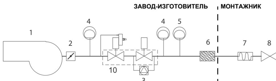
Rp2: Газовая рампа с группой клапанов MBC (2 клапана + газовый фильтр + стабилизатор давления + реле давления) + блок контроля герметичности VPS504
