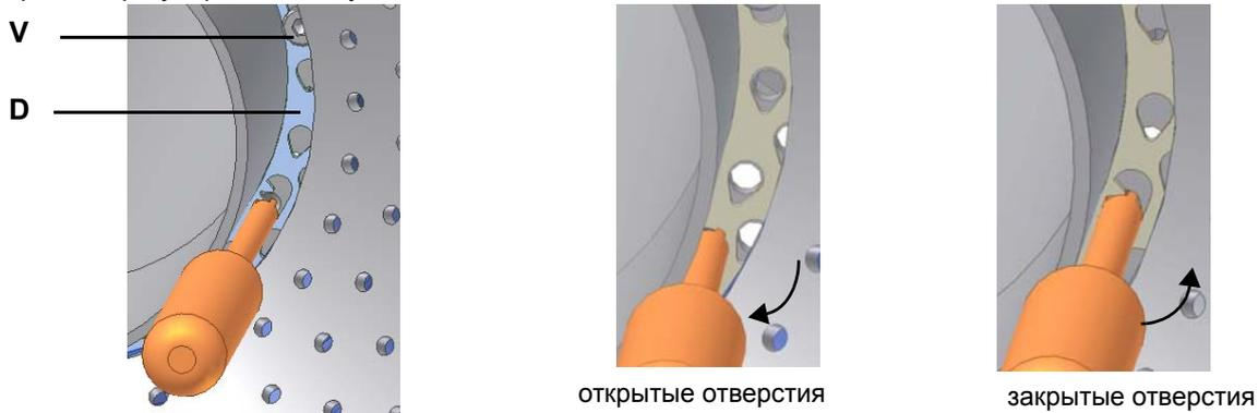
Для работы на сниженной мощности расслабить винт **VB** и постепенно сдвигать голову сгорания в сторону положения "MIN", вращая по часовой стрелке регулировочное кольцо **VRT**. Заблокировать винт **VB** при завершении регулировки.
