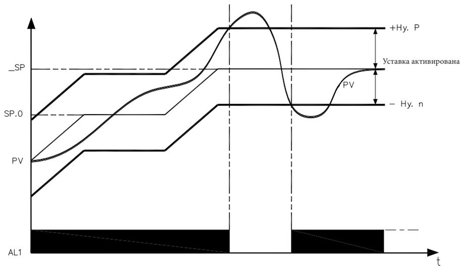
Сигнал о готовности горелки получается при конфигурации Тревоги 1 в качестве относительной обратной с положительным гистерезисом  $Hu.P$  и отрицательным гистерезисом  $Hu.n$
