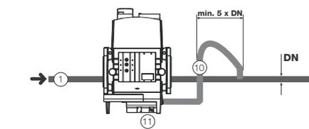
10 = Импульсная трубка
