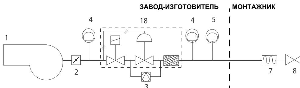
DN65 - DN80: Газовая рампа с группой клапанов MBC (2 клапана + газовый фильтр + стабилизатор давления + реле давления) + блок контроля герметичности VPS504
