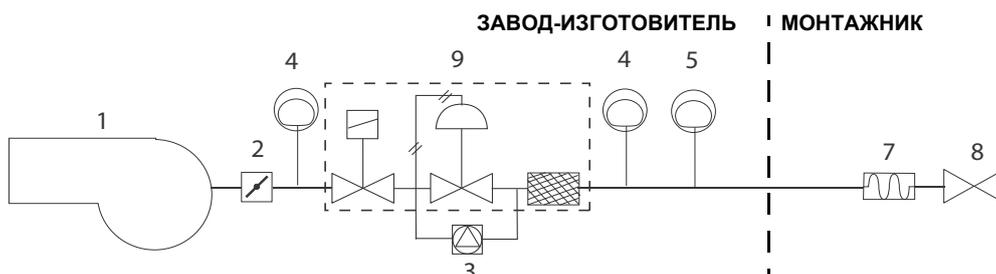
Rp2 - DN65 - DN80: Газовая рампа с группой клапанов VGD со встроенным стабилизатором давления газа + блок контроля герметичности VPS504
