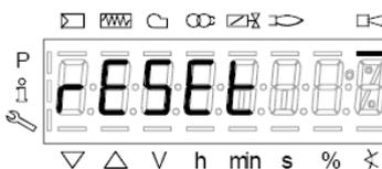
Интерфейс AZL может визуализировать также и код какого - либо случая, который не вызвал блокировку. Дисплей визуализирует текущий код **c**, чередуя его с кодом диагностики **d**:
