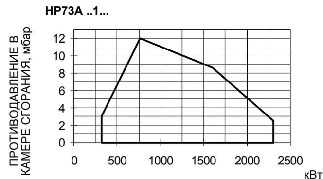
Для получения мощности в ккал/ч, умножьте значение в кВт на 860.
