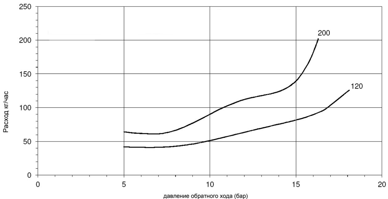
ДАВЛЕНИЕ ТОПЛИВА НА ФОРСУНКЕ = 20 бар. ВЯЗКОСТЬ ТОПЛИВА НА ФОРСУНКЕ = 5 сСт
