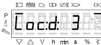
Код диагностики” (Diagnostic code): на примере “Код диагностики: 3”. Зарегистрировать номера и проверить в таблице ошибок тип аварийного случая.
