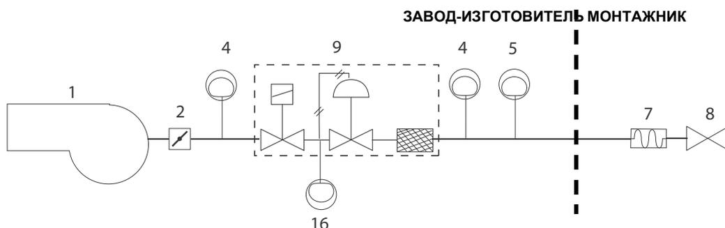
Газовая рампa с группой клапанов VGD 20/40 со встроенным стабилизатором давления газа
