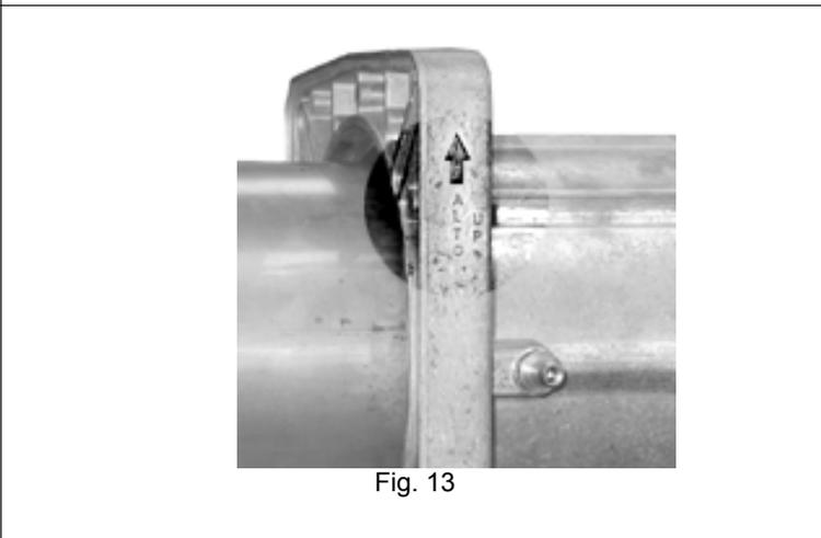
Se viene eseguita la modifica della lunghezza del boccaglio, va adattata anche la lunghezza della testa di combustione come mostrato di seguito.
