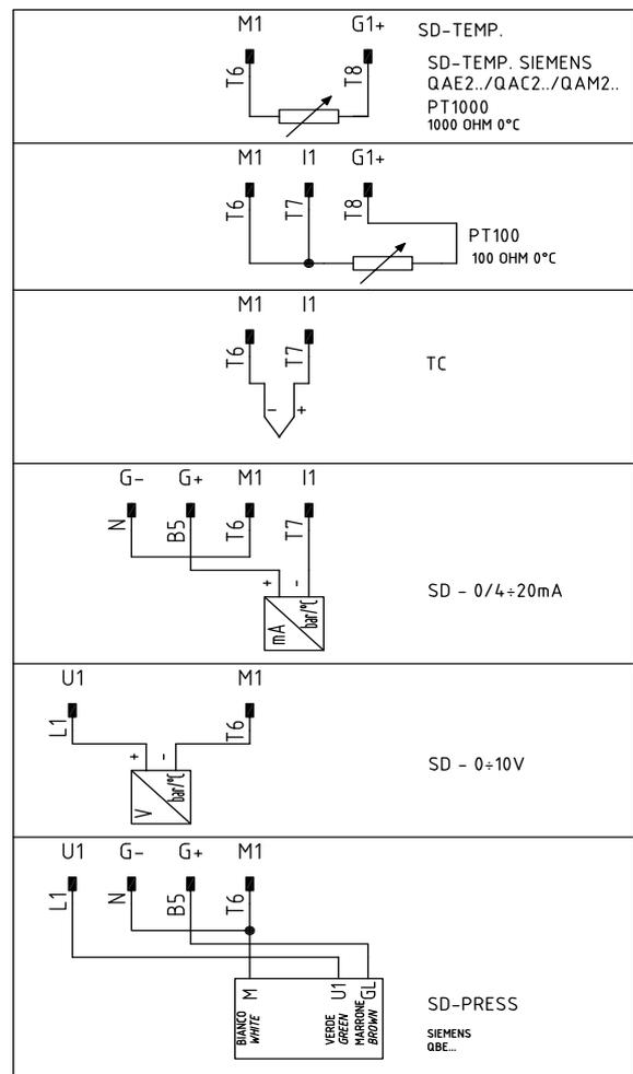
Fig. 34 - Collegamento sonde
