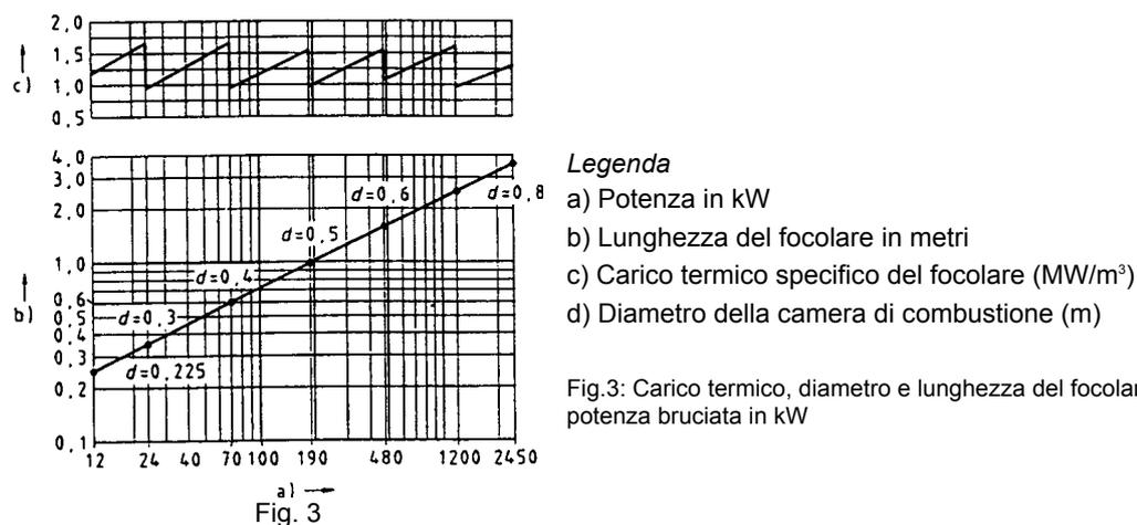
Fig.3: Carico termico, diametro e lunghezza del focolare di prova in funzione della potenza bruciata in kW
