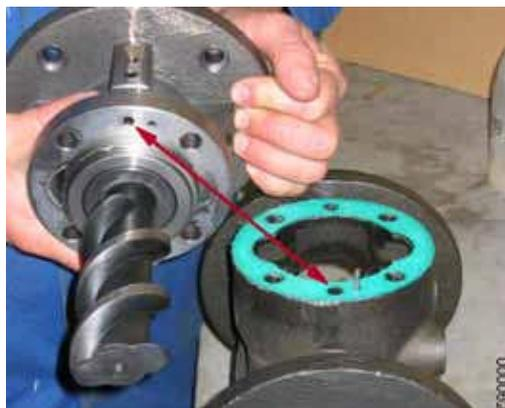
13. Провернуть предварительно собранный узел настолько, чтобы разгрузочное отверстие во фланцевой крышке **074** оказалось в таком же положении, как соответствующее отверстие в корпусе насоса **131**. При этом соблюдать положение цилиндрического штифта **879**.
