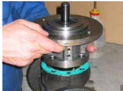
9. Задвинуть предварительно собранный узел из фланцевой крышки и главного винта в корпус насоса, так чтобы главный винт вошел в зацепление с ведомыми винтами. При этом вращать главный винт. Ввернуть и затянуть винты с цилиндрической головкой **914,1** на фланцевой крышке.
