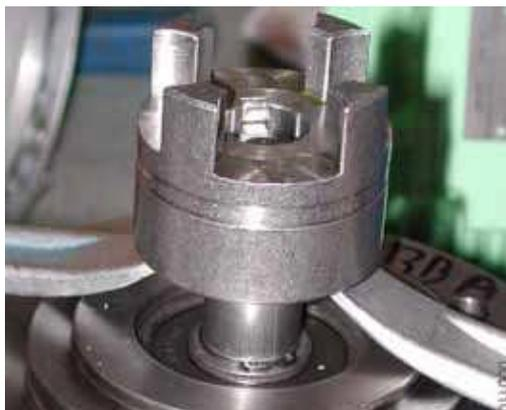
6. Отпустить фиксирующий винт на полумуфте со стороны насоса **052,1** и снять полумуфту с помощью подходящих монтировок.
