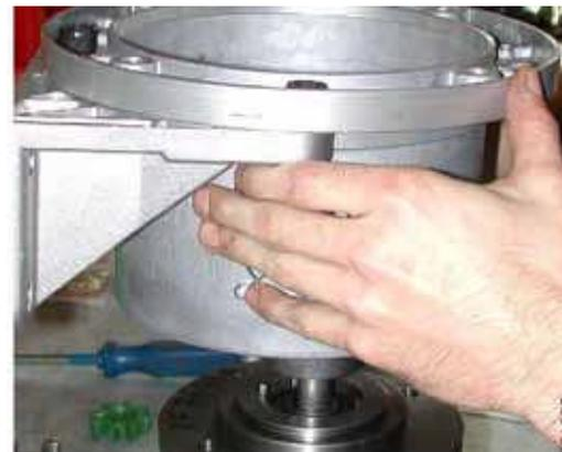
5. Отпустить соединительные винты **914,3** между насосом **001** и держателем **180** и снять с насоса держатель с лапой **526**.
