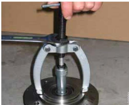
6. С помощью съемника вынуть шарикоподшипник **817** из фланцевой крышки **074**.
