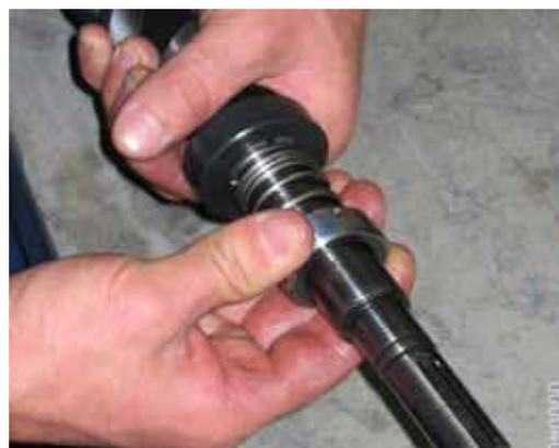
3. Тщательно очистить главный винт **661,1** в зоне торцового уплотнения и смазать его консистентной смазкой. Насадить опорную шайбу **062,1**. Осторожно вращая коническую пружину сжатия **457,6\***, нажимное кольцо **457,5\*** и скользящее кольцо **457,3\*** с уплотнительным кольцом **457,1\*** запчасти, надвинуть их на главный винт. Убедиться в том, что при преодолении буртиков вала уплотнительное кольцо не повреждается.
