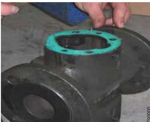
11. Снять с новой прокладки **729,5** пленку для защиты клеевой поверхности. Наложить прокладку на корпус насоса **131** и слегка прижать.
