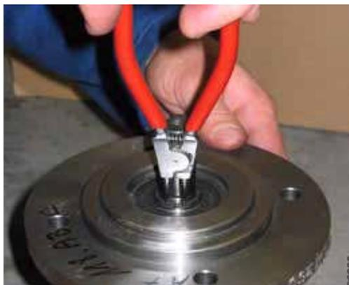
3. Снять кольцо фиксации вала **471,2** и опорную шайбу **056**.
