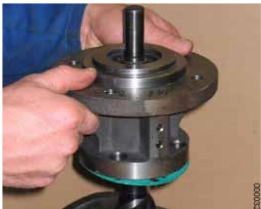
2. Вынуть, выдвигной блок, состоящий из главного винта, подшипниковой опоры, уплотнения и фланцевой крышки, из корпуса насоса **131**.
