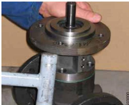
1. Вывернуть четыре винта с цилиндрической головкой **914,1** из фланцевой крышки **074** и отсоединить фланцевую крышку легкими ударами с отскоком.
