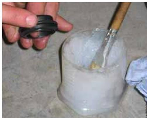
3. Равномерно смазать консистентной смазкой ответное кольцо **457,2\*** запчасти с насаженным уплотнительным кольцом **457,1\***.
