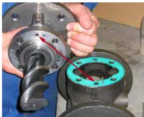
12. Провернуть предварительно собранный узел настолько, чтобы разгрузочное отверстие во фланцевой крышке **074** оказалось в таком же положении, как соответствующее отверстие в корпусе насоса **131**. При этом соблюдать положение цилиндрического штифта **879**.
