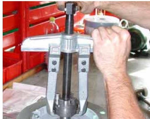
4. Снять полумуфту **052,2** с помощью подходящего приспособления.
