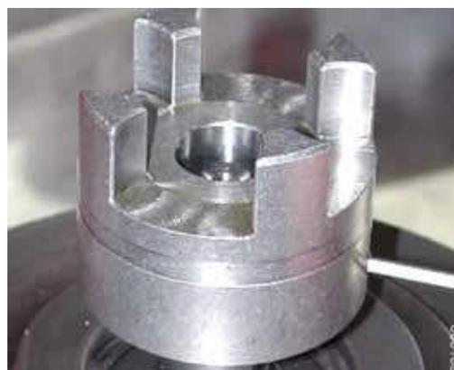
2. Надвинуть полумуфту со стороны насоса **052,1** на вал до промежуточной втулки **052,3**. Монтаж можно облегчить, нагрев муфту до 80...100° С. Затянуть фиксирующий винт полумуфты.
