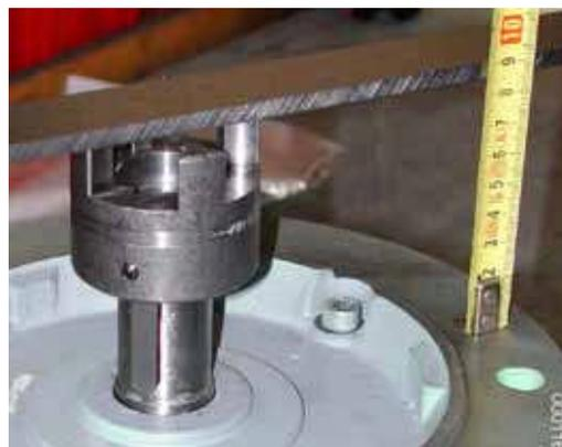
6. Проверить расстояние между торцевой поверхностью зубьев муфты и соединительной поверхностью фланца двигателя. Это расстояние необходимо отрегулировать на значение  $x - c$  (см. Таб. 2, стр. 24).
