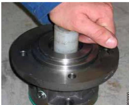
6. Мягкой оправкой осторожно выжать ответное кольцо **457,2\*** торцового уплотнения из фланцевой крышки **074**.
