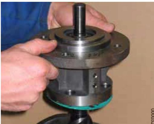
2. Вынуть выдвижной блок, состоящий из главного винта, подшипниковой опоры, уплотнения и фланцевой крышки, из корпуса насоса **131**.
