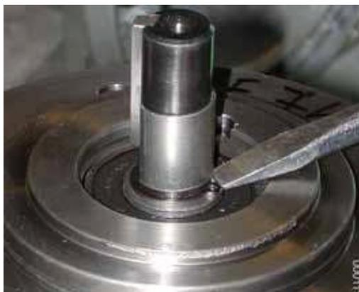
7. Снять с вала промежуточную втулку **052,3** муфты.
