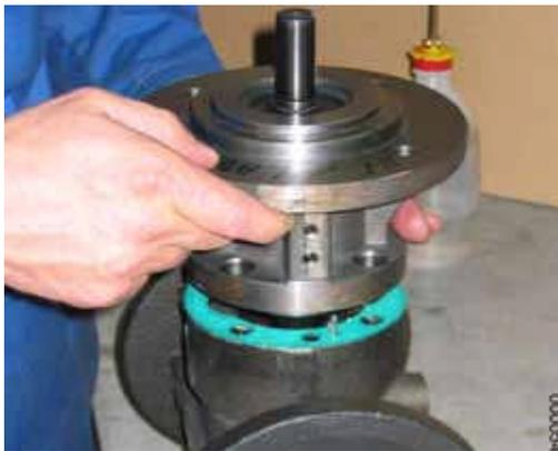
9. Задвинуть предварительно собранный узел из фланцевой крышки и главного винта в корпус насоса, так чтобы главный винт **661,1** вошел в зацепление с ведомыми винтами **661,2**. При этом вращать главный винт. Ввернуть и затянуть винты с цилиндрической головкой **914,1** на фланцевой крышке.
