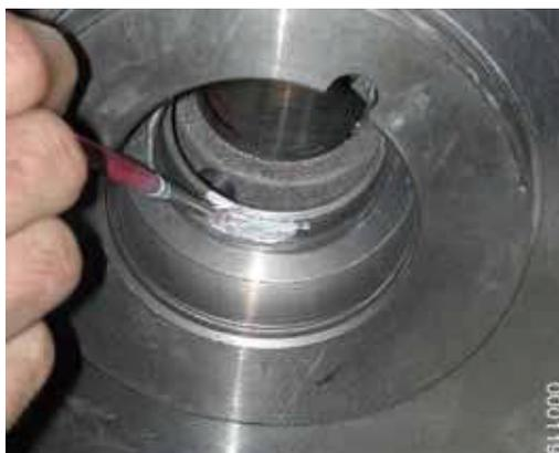
2. Нанести на посадочную поверхность для уплотнительного кольца во фланцевой крышке герметик для резьбы Loctite 572 (или иное аналогичное средство). При монтаже уплотнительного кольца жидкий герметик служит в качестве смазочного материала, а после отверждения - для фиксации против проворачивания.
