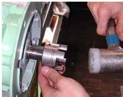
5. Насадить полумуфту со стороны двигателя **052,2** легкими ударами мягкого молотка по концу вала двигателя. Монтаж можно облегчить, нагрев муфту до 80...100°C.
