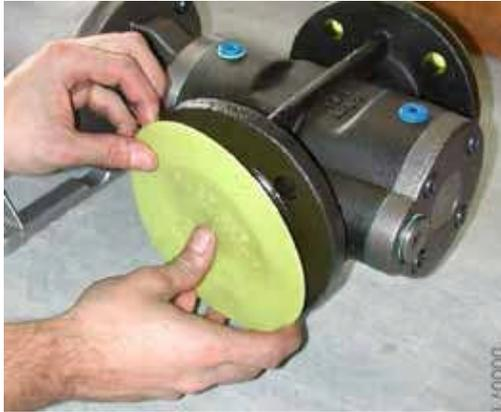
1. Перед демонтажем закрыть впускное и выпускное отверстие насоса подходящими крышками для защиты от твердых частиц и грязи.
