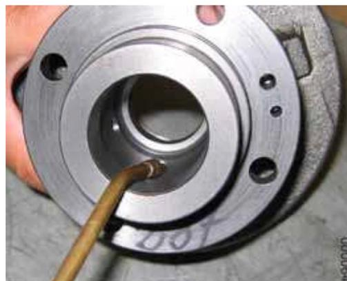
2. Тщательно очистить поверхность прилегания уплотнительного кольца во фланцевой крышке.
