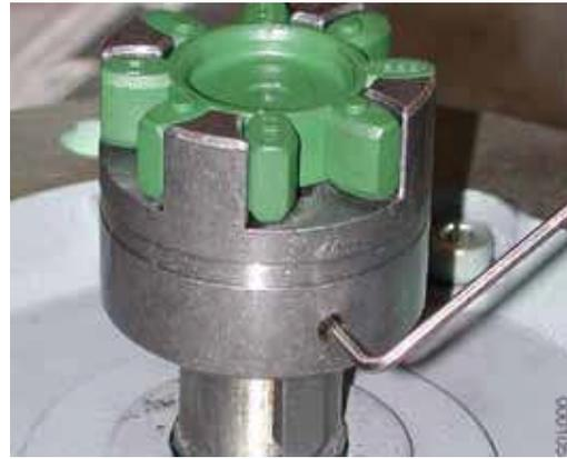
3. Отпустить фиксирующий винт на полумуфте **052,2** со стороны электродвигателя.
