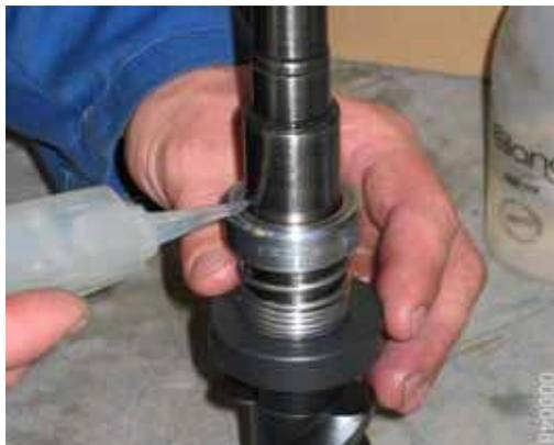
8. Тщательно очистить промывочным бензином поверхности скольжения скользящего кольца **457,3\*** и ответного кольца **457,2\***, а затем смазать их одной каплей смазочного масла, не содержащего смолы. После этого более не дотрагиваться до поверхностей скольжения.
