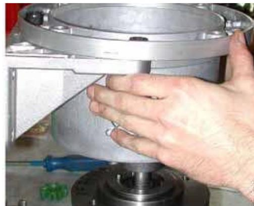
3. Насадить на насос держатель **180** с лапой **526** и затянуть соединительные винты **914,3** между насосом и держателем.
