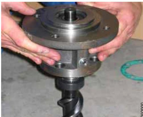
9. До упора запрессовать главный винт с надвинутыми деталями запасного уплотнения в шарикоподшипник **817** во фланцевой крышке **074**.
