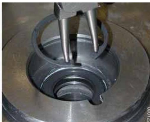
6. Вставить опорную шайбу **745,2\*\*** и кольцо **745,1\*\*** для осевой фиксации радиального уплотнительного кольца **745,3\*\***.
