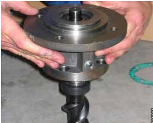
5. До упора запрессовать главный винт с надвинутыми деталями запасного уплотнения в шарикоподшипник **817** во фланцевой крышке **074**.
