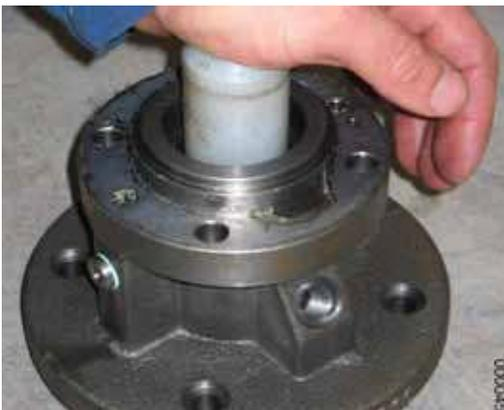
5. С помощью мягкой оправки вдавить ответное кольцо **457,2\*** во фланцевую крышку ровень до упора.
