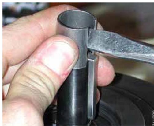
1. Надвинуть промежуточную втулку **052,3** муфты вровень на кольцо фиксации подшипника.
