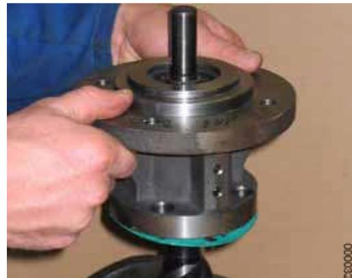
3. Вынуть выдвижной блок, состоящий из главного винта, подшипниковой опоры, уплотнения и фланцевой крышки, из корпуса насоса **131**.
