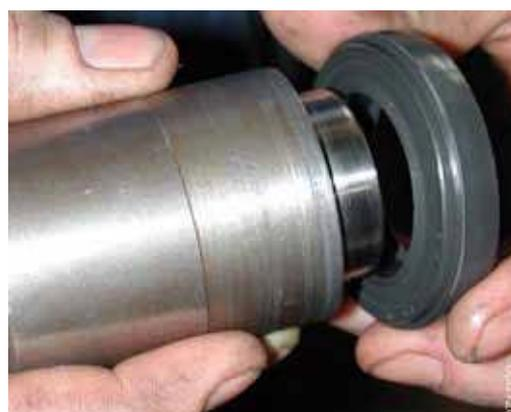
3. Подготовить подходящую оправку для монтажа уплотнительного кольца. Оправка должна плоско прилегать к опорному элементу уплотнительного кольца и не должна иметь острых краев в зоне уплотнительной кромки.
