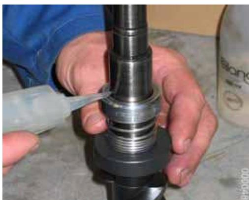
4. Тщательно очистить поверхности скольжения скользящего кольца **457,3\*** и ответного кольца **457,2\*** промывочным бензином и смазать их одной каплей смазочного масла, не содержащего смолы. После этого более не дотрагиваться до поверхностей скольжения.
