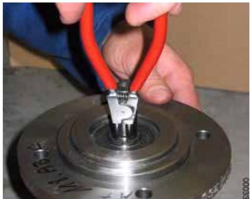
3. Снять кольцо фиксации вала **471,2** и опорную шайбу **056**.
