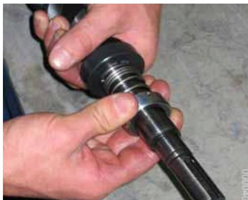
8. С легким вращении сдвинуть вниз скользящее кольцо **457,3\*** с конической пружиной сжатия **457,6\***, нажимное кольцо **457,5\*** и уплотнительное кольцо **457,4\*** с главного винта. Снять с вала опорную шайбу **062,1**.
