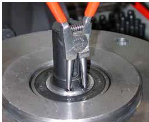
11. Надвинуть опорную шайбу **056** и смонтировать кольцо **471,2** для фиксации главного винта.
