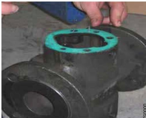
12. Снять с новой прокладки **729,5** пленку для защиты клеевого слоя. Наложить уплотнение на корпус насоса **131** и слегка прижать.
