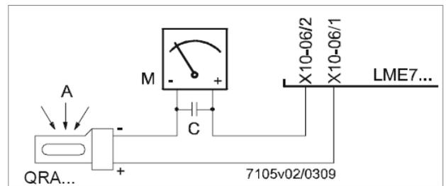
Fig. 14: Rilevazione con fotocellula QRA..
