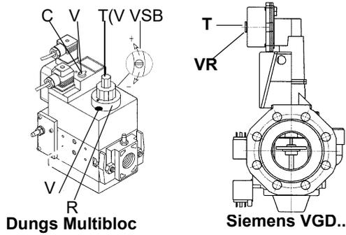
**⚠** El grupo de regulación de presión es configurado en fábrica. Los valores ajustados han de ser adaptados "in situ" a las condiciones de la instalación. ¡Seguir siempre las indicaciones del fabricante del quemador!
