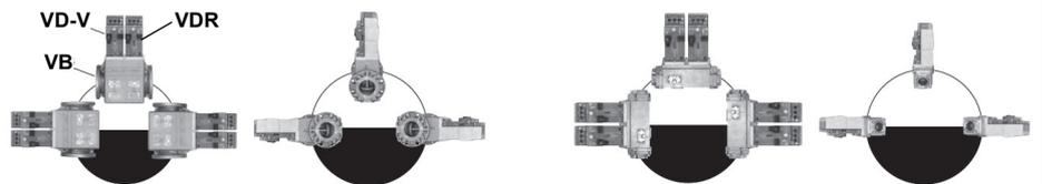
**Posiciones de montaje MBE / VB / VDMontaje VD-R & PS...**
