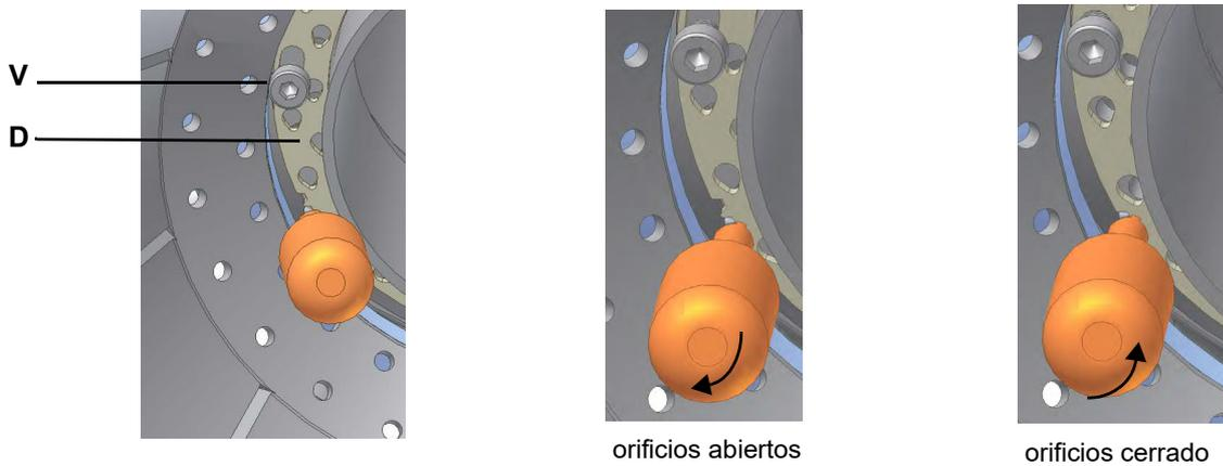
El disco se debe regular durante la puesta en funcionamiento de la instalación.
