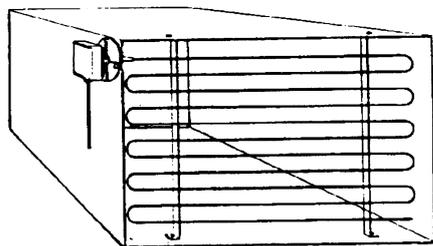
Etaler sur toute la section du canal, distance minimale des parois 50mm, rayon de courbe 10mm pour les sondes de 2 ou 6m
