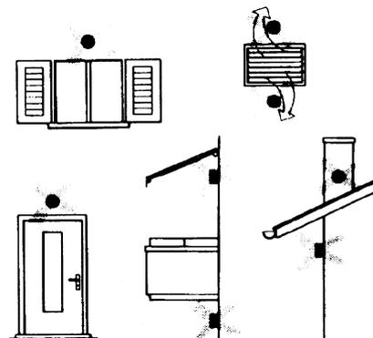
Eviter le montage en proximité de fenêtres, grilles d'aération à l'extérieur de la chaufferie, sur les cheminées ou protégés par des balcons ou toitures.
