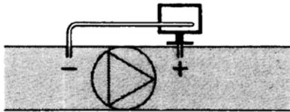
B - Contrôle d'un ventilateur (amont / en aval)
