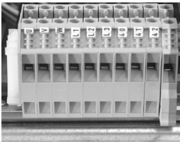
Bornera de conexión en circuito impreso
