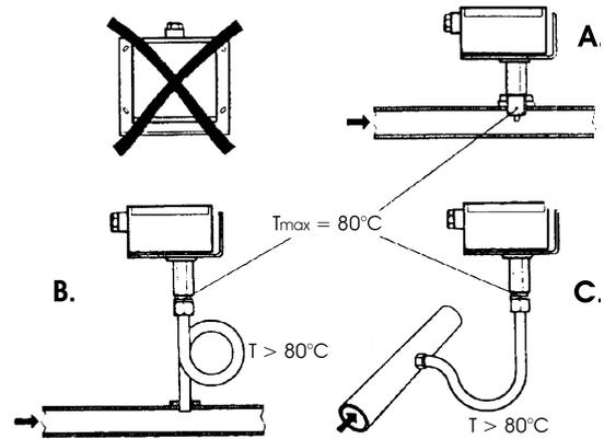
Curvar a mano (jamás con un instrumento) la sonda de 0,4 m, como indicado en la figura..
