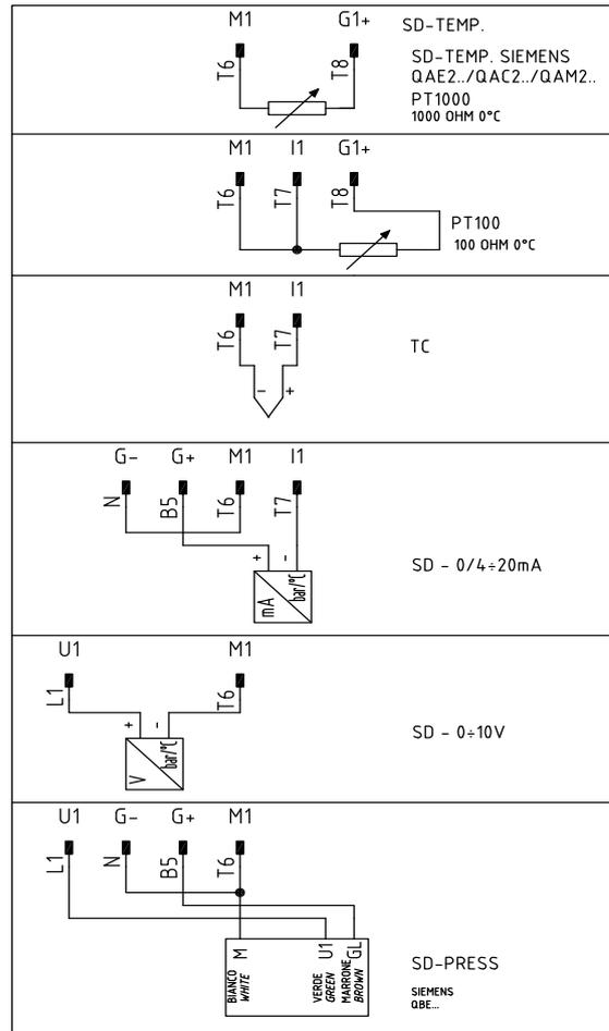
Fig. 29 - Connettore a 7 poli per collegamento sonde
