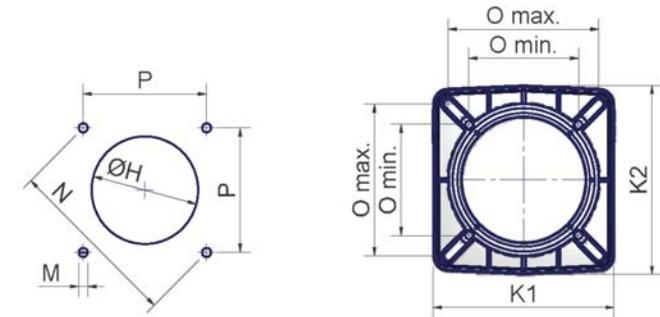
Fig. 5: Foratura caldaia e flangia bruciatore
