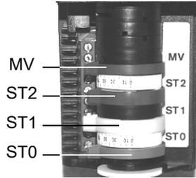
Siemens SQN72.4A4Axx (modelos progresivos y modulantes)
