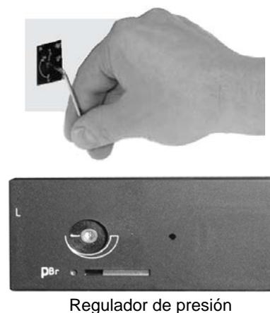
**Grupo valvolas DUNGS MB-DLE:** Antes poner en funcionamiento el quemador, regular la apertura lenta del grupo de válvulas: para regular la apertura lenta, quitar la calota **T** (véase figura), voltearla y colocarla en el perno **VR** con ranura correspondiente ubicada en la parte superior. Enroscando el caudal de encendido disminuye, mientras que desenroscando, el caudal de encendido aumenta. No regular el tornillo **VR** con un destornillador.
