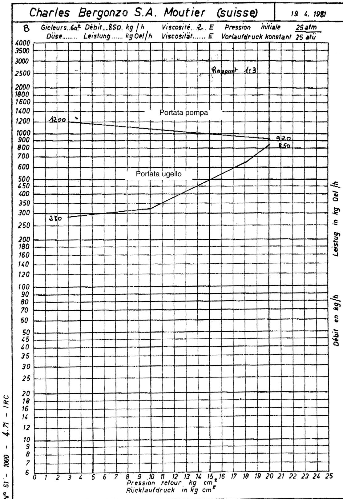
Fig. 23 - Ugello Bergonzo - Esempio con ugello da 850 kg/h
