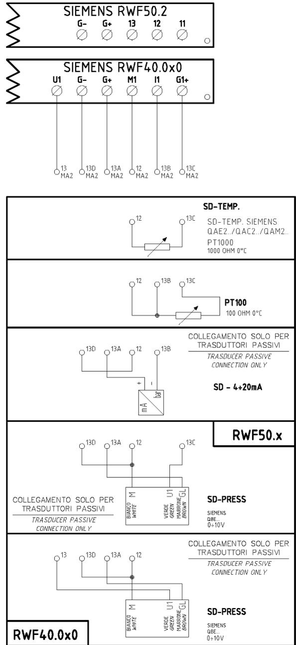
Соответствия клемм между модуляторами RWF50.2 и RWF40.0x0
