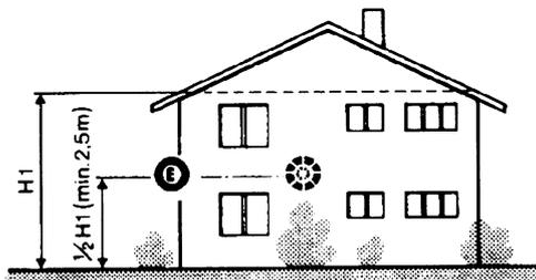
**Общее правило:** ep на наружной стене здания, соответствующей залу, никогда на стене, обращенной на юг или в положении, при котором утром попадают лучи солнца. В случаях сомнения лучше разместить на северной стене или на северо-западной стене.
