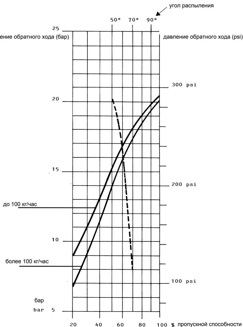
**ДАВЛЕНИЕ ТОПЛИВА НА ФОРСУНКЕ = 25 бар**
