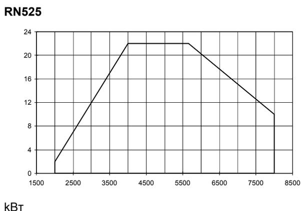
Чтобы получить мощность в ккал/ч, умножьте значение в кВт на 860.
