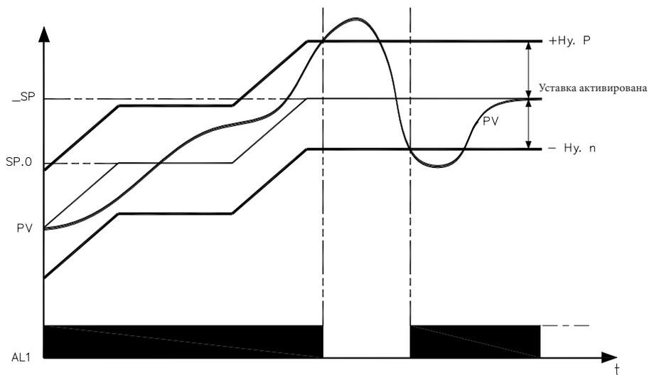
Сигнал о готовности горелки получается при конфигурации Тревоги 1 в качестве относительной обратной с положительным гистеризом  $H_{y.P}$  и отрицательным гистеризом  $H_{y.n}$
