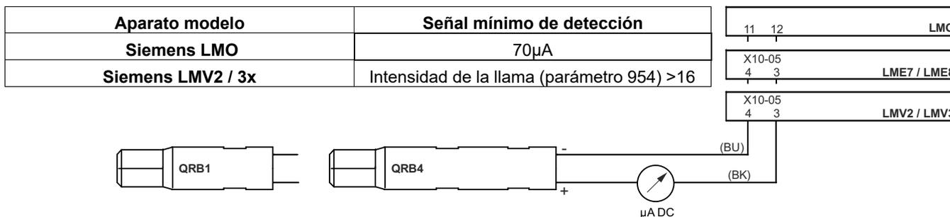
Fig. 1: Detección con fotocélula QRB4 - QRB1
