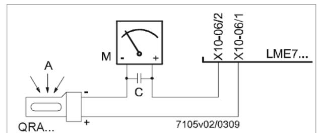
Fig. 9: Rilevazione con fotocellula QRA..
