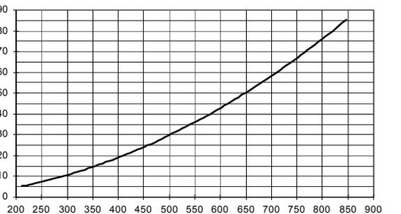
**Curve pressione in testa di combustione - portata gas (GPL)**
