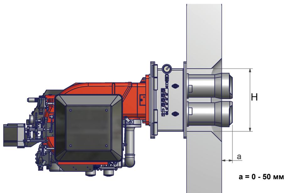
**ВНИМАНИЕ:** уделить особое внимание монтажу горелки: все сопла должны входить вовнутрь камеры сгорания, должны выходить за пределы внутренней части передней стенки котла.
