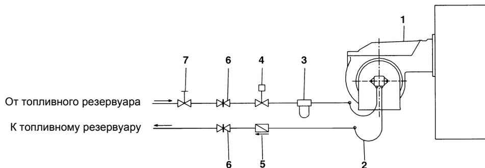
Рис. 1 - Двухтрубная система
