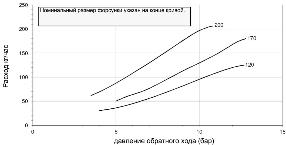
ДАВЛЕНИЕ ТОПЛИВА НА ФОРСУНКЕ = 20 бар. ВЯЗКОСТЬ ТОПЛИВА НА ФОРСУНКЕ = 5 сСт
