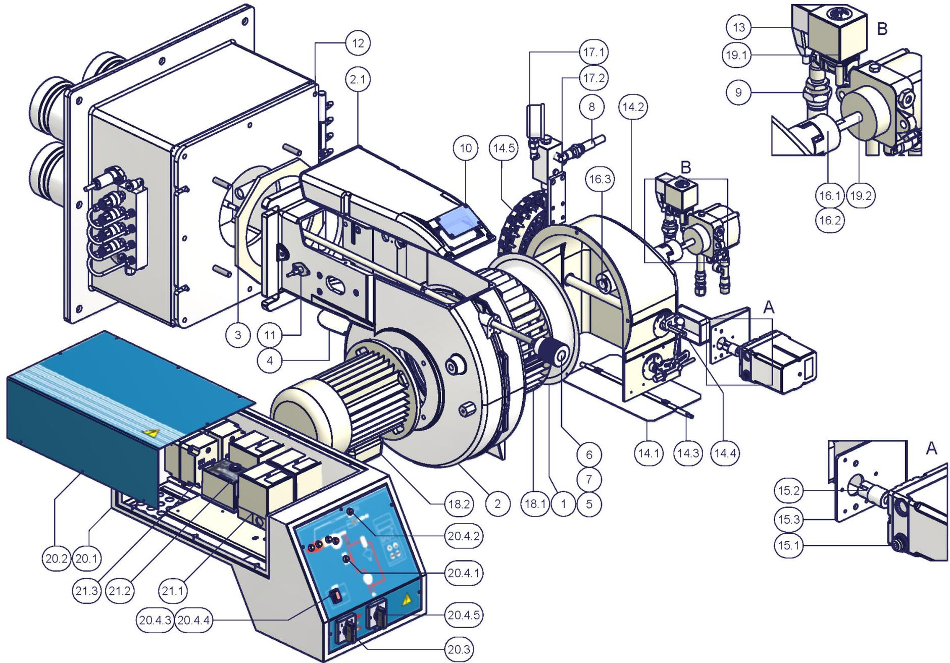
**ОБОРУДОВАНИЕ УПРАВЛЕНИЯ И КОНТРОЛЯ SIEMENS ДЛЯ ГОРЕЛОК НА ДИЗЕЛЬНОМ/ЖИДКОМ БИОТОПЛИВЕ LOA24**
