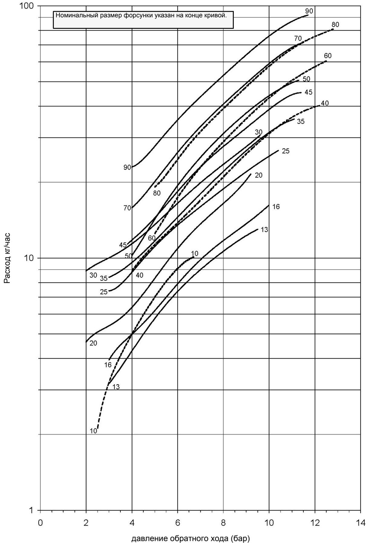
ДАВЛЕНИЕ ТОПЛИВА НА ФОРСУНКЕ = 20 бар. ВЯЗКОСТЬ ТОПЛИВА НА ФОРСУНКЕ = 5 сСт
