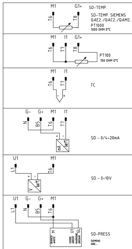
Рис. 3 - Подсоединение датчиков
