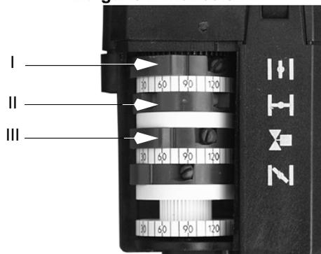
En esto servomando no está previsto el mando manual de la compuerta del aire. La regulación de la leva se realiza sobre el tornillo colocado dentro de la leva.
