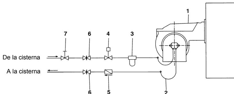
Fig. 10 - Sistema bitubo
