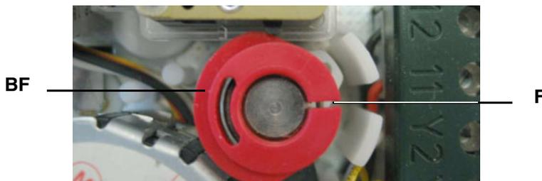
23 La posición de llama baja no debe coincidir nunca con la posición de encendido y por este motivo, la excéntrica **BF** se debe calibrar por lo menos a 20° - 30° más respecto a la posición de encendido
