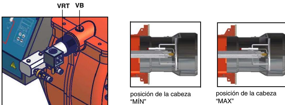
**Atención:** si se modifica la posición de la cabeza, repetir las regulaciones de aire y gas descritas en los puntos anteriores.
