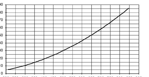
**Curvas de presión - caudal en cabezal de combustión (LPG)**
