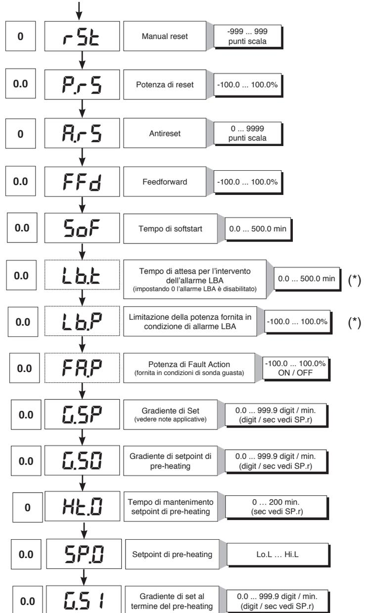
(\*) Se l'allarme LBA è attivo, si può annullare premendo i tasti Δ + ▽ quando sul display è visualizzato il valore dell'uscita di regolazione (OutP), oppure commutando in Manuale.
