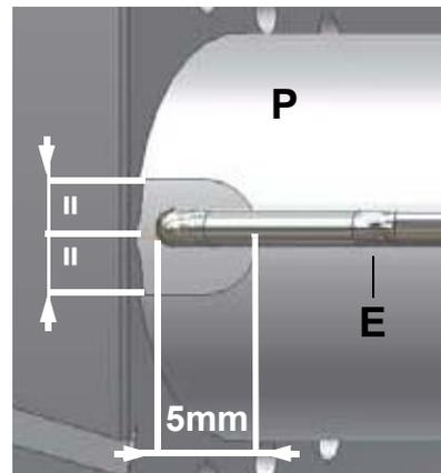
Fig. 30 - Particolare del diffusore con pilota (P) e elettrodo di accensione (E)
