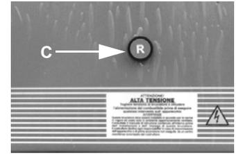
Fig. 14 - Botón de desbloqueo (versión con equipo sin desbloqueador a distancia)
