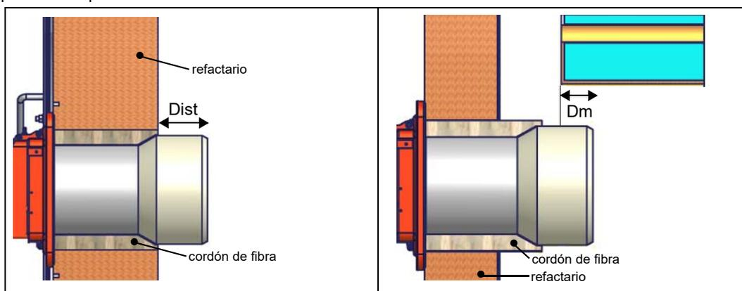
**Sellar el espacio entre la tobera y el material comprimido refractario, con material aislante (cordón de fibra resistente a la temperatura o cemento refractario).**
